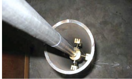
Figura 4. Monitoreo de zonas de concentración de esfuerzos en una tubería usada para la perforación de un pozo petrolero. 3
