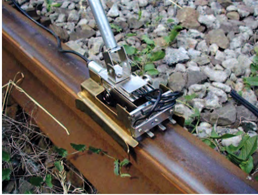
Figura 3. Detección de zonas de concentración de esfuerzos y grietas en riel de ferrocarril usando el método de memoria magnética. 1
